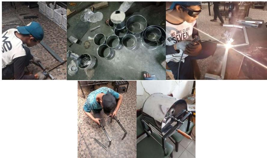
Gambar 6. Pembuatan alat sangrai penghilang debu kopi kulit di bengkel
