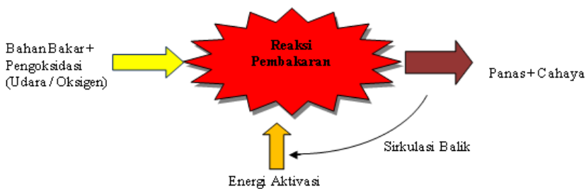
Gambar 2.2 Ilustrasi Proses Pembakaran (Wardana, 2008)
