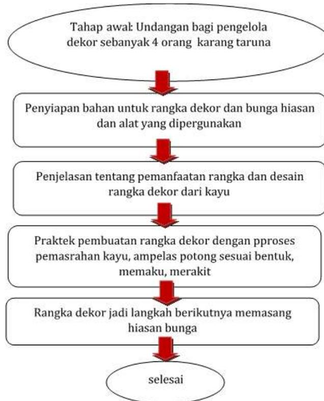
Gambar 1. Tahapan pembuatan rangka dekor
