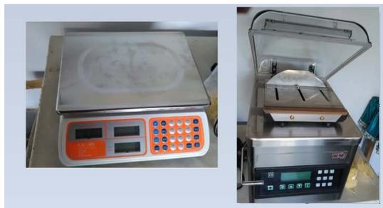
Gambar 8. Timbangan Digital dan Mesin Vaccum Sealer
