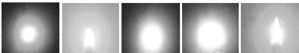
Gambar 2. Profil nyala api pembakaran bahan bakar nabati. Berurutan dari kiri ke kanan : minyak kapuk, minyak nyamplung, minyak sawit, minyak kapas, dan minyak jarak pagar
