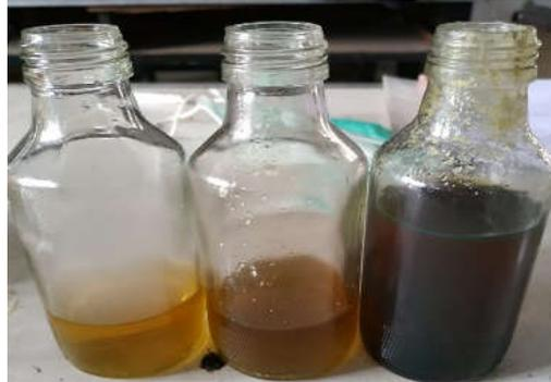
Gambar 5. Warna tar hasil pirolisis minyak jelantah
