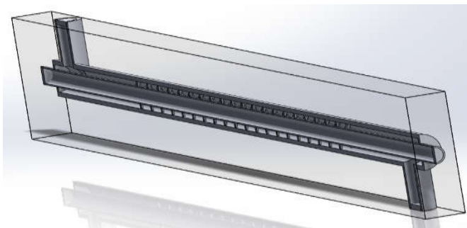
Gambar 5. Alat penukar kalor yang sudah di assembly
