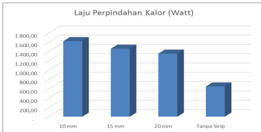
Gambar 11. Laju perpindahan kalor dengan variasi jarak sirip
