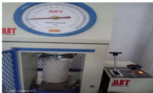
Gambar 3. Proses pengujian kuat tekan beton
