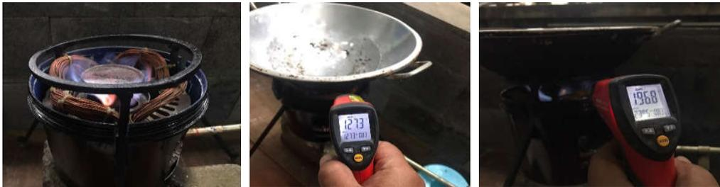
Gambar 5. Kompor hasil modifikasi dan pengujian kinerja
