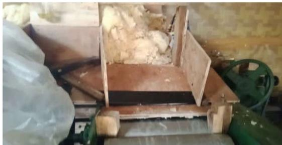
Gambar 7. Penyiapan adonan sebelum masuk mesin roll adonan kerupuk singkong
