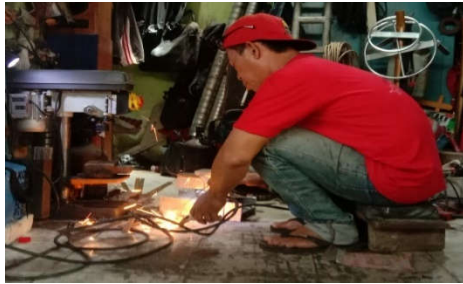
Gambar 2. Pekerjaan Pengelasan dengan Merokok dan Tanpa Menggunakan APD
