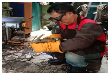
Gambar 6 Pekerjaan Menggerinda Menggunakan APD
