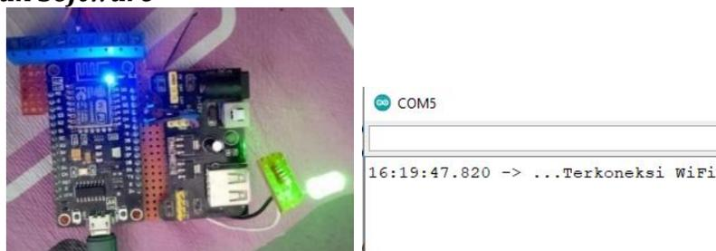
Gambar 6. Rangkaian lampu indikator
