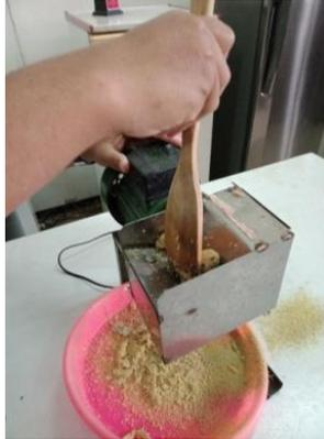
Gambar 3. Proses pamarutan jahe dengan mesin parut listrik
