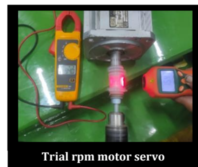
Gambar 6. Implementasi Modifikasi Motor Servo menjadi Generator
