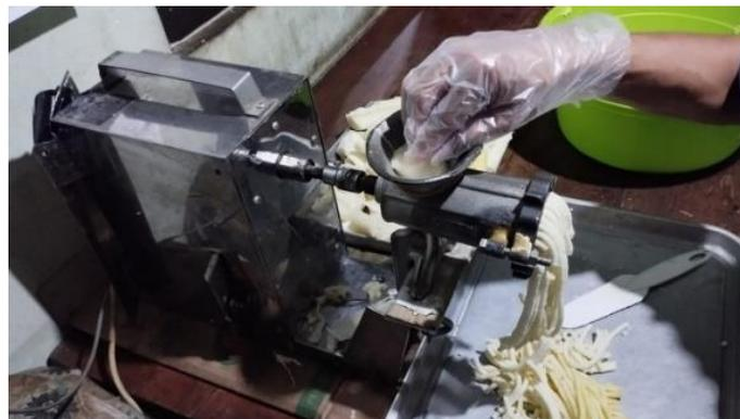
**Gambar 3.** Pendampingan Penggunaan Alat Penggiling Singkong dengan Dinamo
