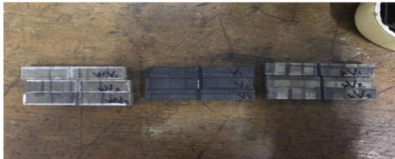
Gambar 2. Spesimen Uji Impak setelah proses pencetakan komposit dengan metode vaccum infusion resin
