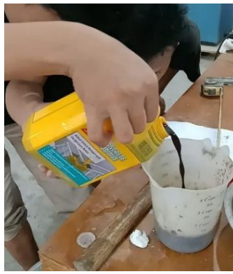
Gambar 2. Bahan tambah beton a) Abu vulkanik b) Sika dan c) Serat sedotan
