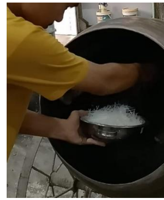
Gambar 2. Bahan tambah beton a) Abu vulkanik b) Sika dan c) Serat sedotan
