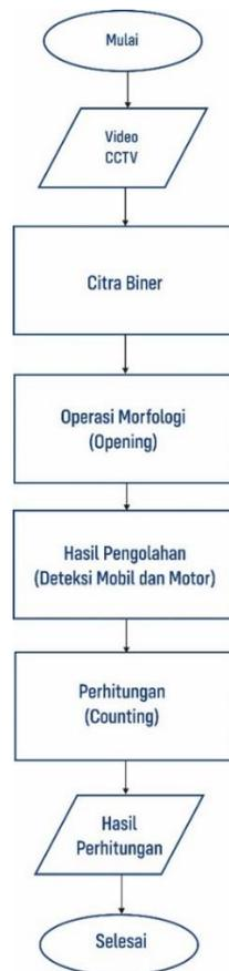
**Gambar 2.** Diagram Alur Proses Aplikasi Deteksi Jumlah Kendaraan Bermotor Melalui Video CCTV
