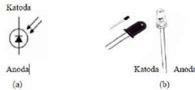
Gambar 1 (a) Simbol dari Photodioda (b) Bentuk fisik dari Photodioda
