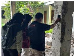
(b) Rebar Scan pada Kolom
