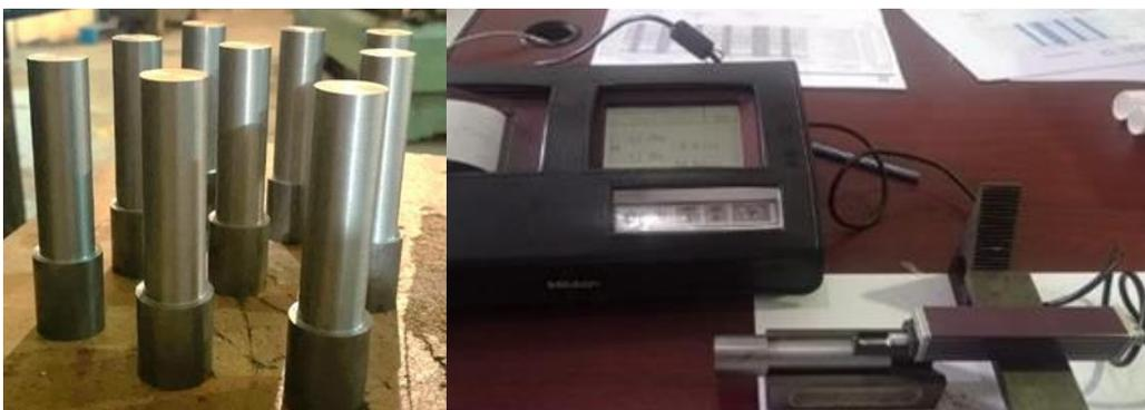
**Gambar 5.** Hasil Pembubutan **Gambar 6** Pengujian dengan Mitutoyo SJ 310
