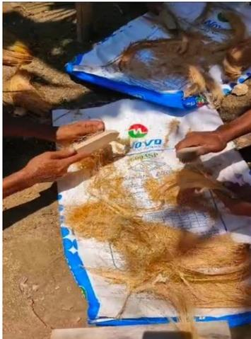
**Gambar 4.** Demo Pengolahan Sabut Kelapa Menjadi *Cocopeat* Menggunakan Sisir Baja dengan Hasil Samping *Cocofiber*
