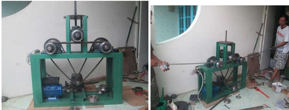
Gambar 2. Mesin Roll Pipa Besi dan penggunaannya untuk produksi
