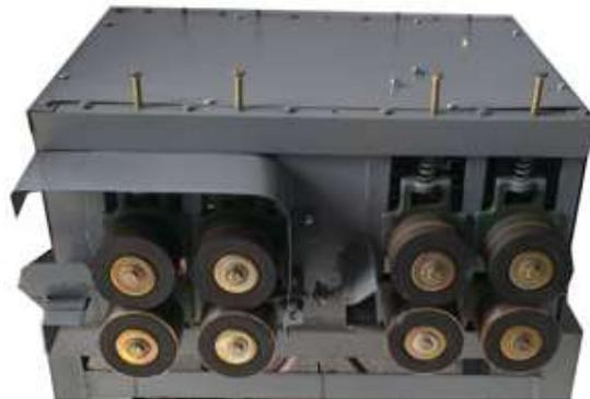
Gambar 1. Mesin Rajang Bambu
