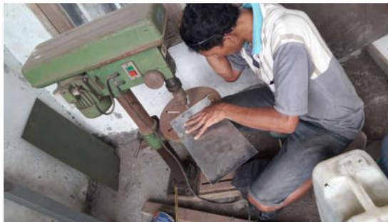
Gambar 5. Pembuatan lubang baut pada pelat papan nama jalan
