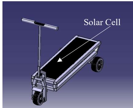
Gambar 2. Desain Tiga Dimensi Electric Scooter Berbasis Solar Cell
