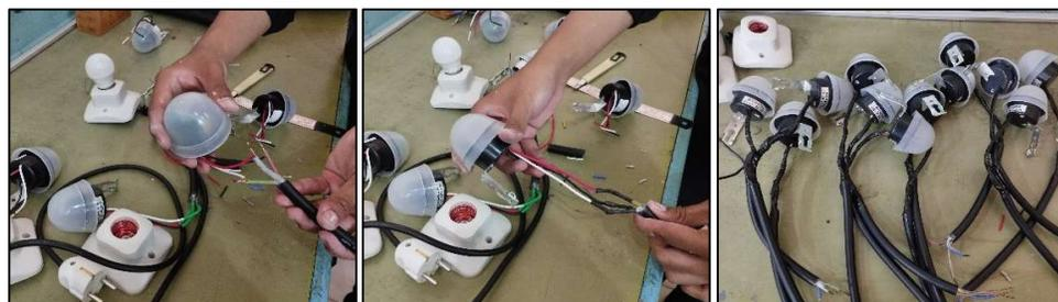
Gambar 6. Proses penambahan kabel pada *photocell*
