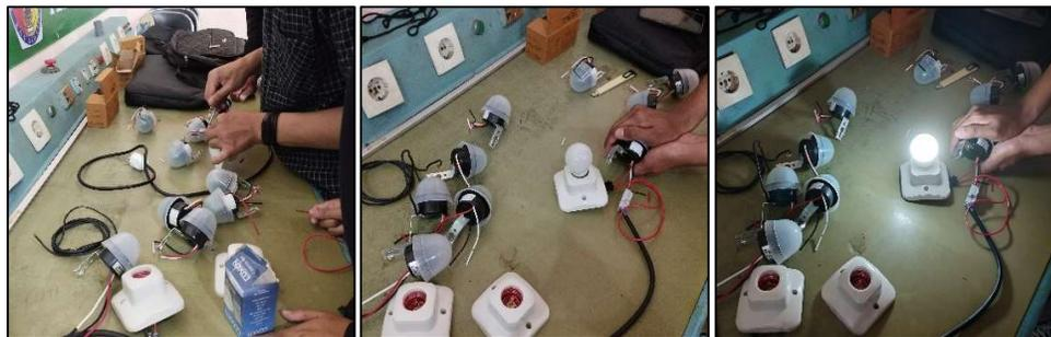
Gambar 5. Proses perakitan dan uji coba *photocell*
