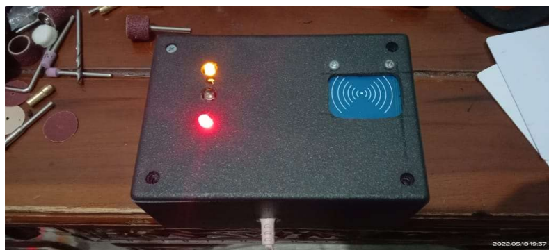
Gambar 6. Indikator Menyala Saat Sensor Getar SW-420 Mendeteksi Getaran Tertentu
