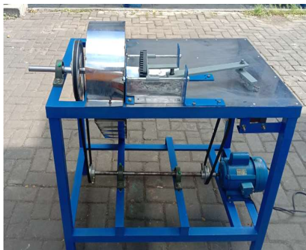
Gambar 5. Hasil akhir Pembuatan berupa Mesin Perajang Wortel Metode Pemotongan Vertikal Kapasitas 75 Kg/Jam
