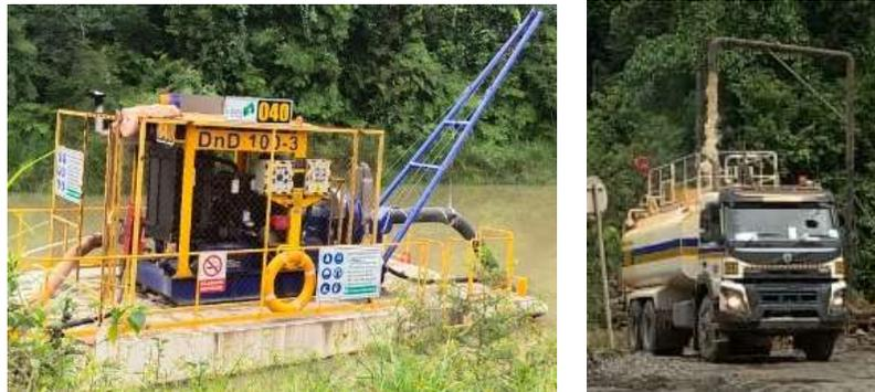
Gambar 1. *Waterfill* Pengisian Tangki Air *Water Truck* dengan Sistem Manual
