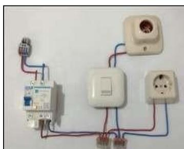
Gambar 8. Rangkaian uji coba RCBO
