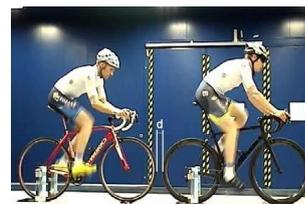
Gambar 12. Uji terowongan angin pembalap dengan jarak  $d$  (Belloli et al., 2016)
