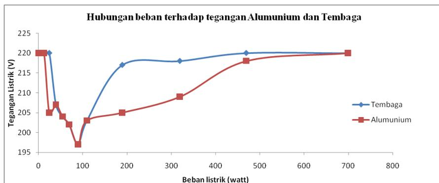
Gambar 14 Hubungan beban terhadap tegangan kumparan alumunium dan tembaga
