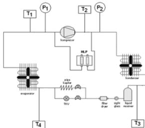
Gambar 4. Skema unit alat uji sistem refrigerasi
