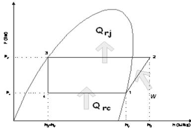
Gambar 2. Siklus refrigerasi kompresi uap ideal pada diagram tekanan-entalpi (P-h).
