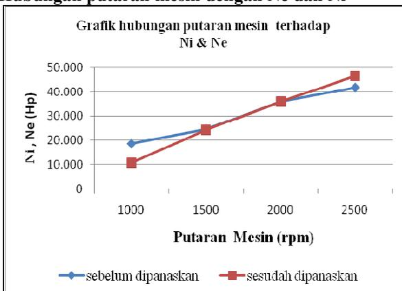
Gambar 8. Grafik hubungan putaran mesin dengan daya indikasi (Ni) dan daya efektif (Ne)
