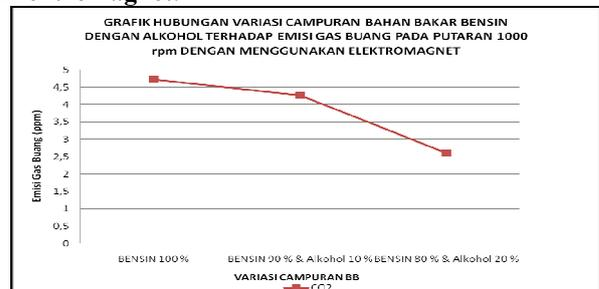
Gambar 12. Grafik Hubungan Variasi Campuran Bahan Bakar Bensin denganAlkohol Terhadap Emisi Gas Buang Pada Putaran 1000 rpm dengan menggunakan Elektromagnet
