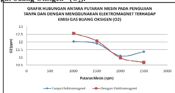
Gambar 11. Grafik Hubungan putaran mesin pada pengujian tanpa dan dengan menggunakan elektromagnet terhadap emisi gas buang Oksigen (O<sub>2</sub>)
