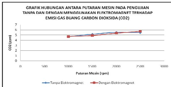
Gambar 9. Grafik Hubungan putaran mesin pada pengujian tanpa dan dengan menggunakan Elektromagnet terhadap emisi gas buang Carbon Dioksida (CO<sub>2</sub>)
