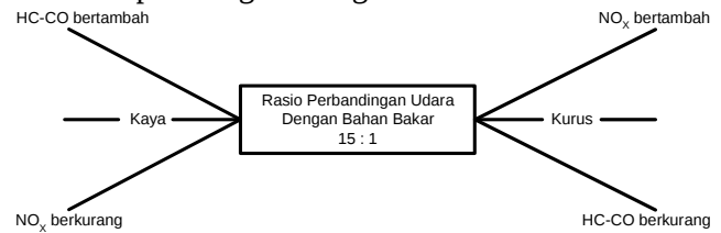
Gambar 8. Rasio Perbandingan Antara Udara dengan Bahan Bakar Terhadap Kadar HC, CO, NO x
