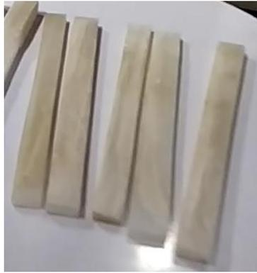
Gambar 11. Hasil spesimen ASTM D7264
