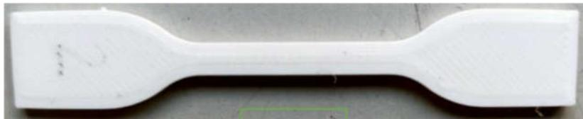
Gambar 3. Spesimen uji tarik
