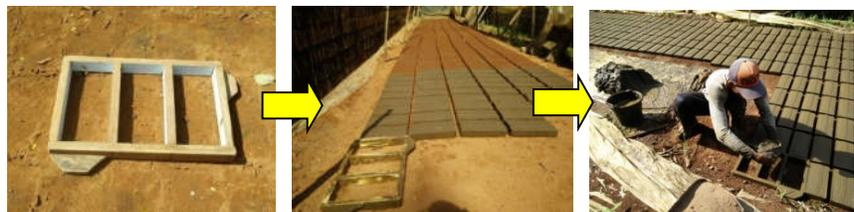
Gambar 2. Proses Pencetakan Batu Bata
